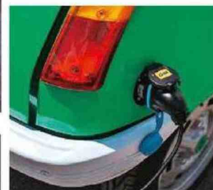
Una vecchia Renault R5 il cui motore termico è stato «rimpiazzato» da quello elettrico. Di recente la casa francese ha fatto sapere che un kit retrofit è ora disponibile per questo tipo di vettura.
